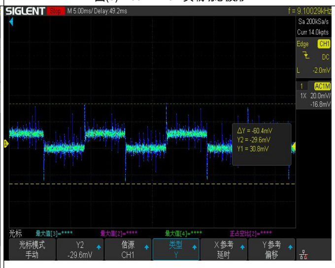
图(6) 50% ~ 75%负载动态波形
